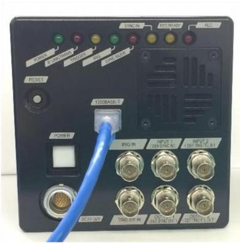
Insert a LAN cable to “1000BASE-T” connector.
